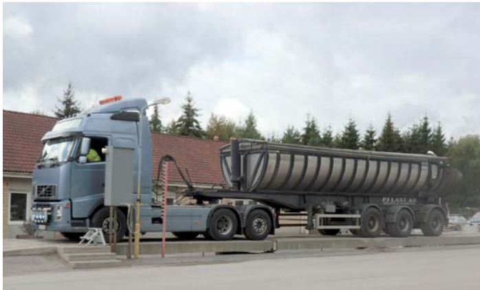
Bild 3-5 En snabb och smidig semitrailer tar 32-35 ton asfalt.
