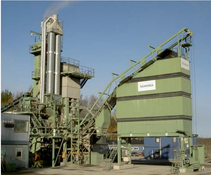
Bild 5-1 Vattenångorna kondenserar i vertikala rör vid sidan av filtret. Vattnet samlas upp i sedimentationstankar.
