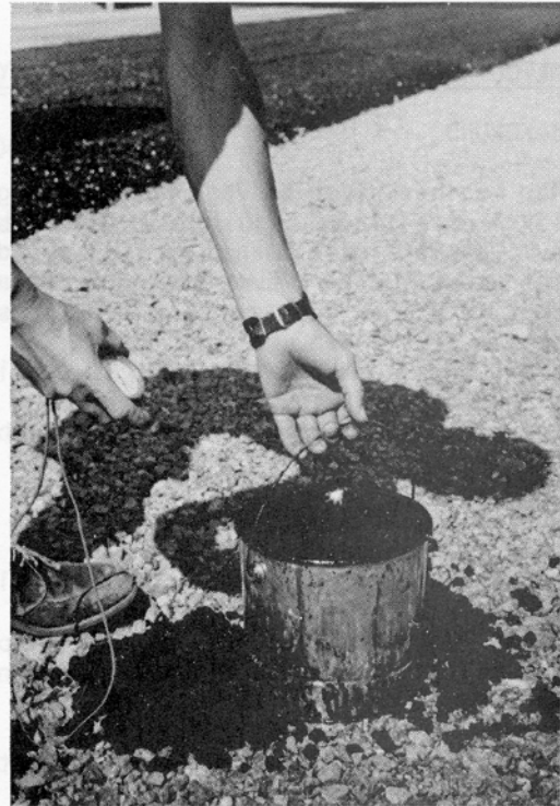
BILD 2. Hinken lyfts och kronometern startas.
