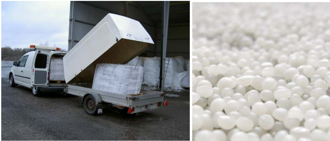
Bild 6-4 Sasobit anskaffades till Skanskas asfaltverk i Dalby för blandningsförsök. Sasobit levereras i storsäck i form av små kulor.
