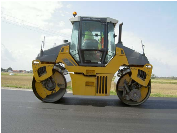
Bild 3-2 En vält som kavlar och slår behöver en asfaltmassa som både bär och ger efter.
